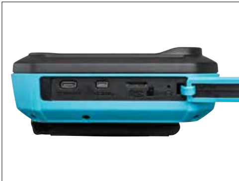
HDMI port k video výstupu, USB-C k nabíjení, micro SD
